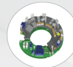
Accionamiento de baja tensión hueco grande
