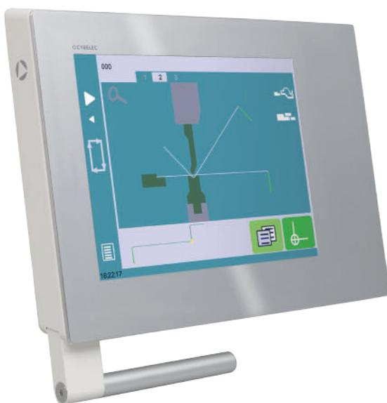
Il CybTouch 15 PS è un controllo numerico 2D specificamente dedicato alle presse piegatrici CNC di fascia media. Si presenta in un alloggiamento compatto, simile alla nota gamma CybTouch, ma con un touchscreen più grande e un nuovo design orizzontale.
